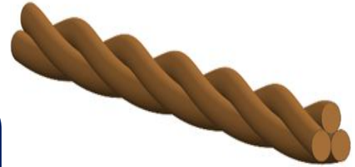
CICC超导电缆一级电缆模型的建立
