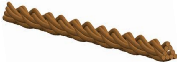
CICC超导电缆二级电缆模型的建立
